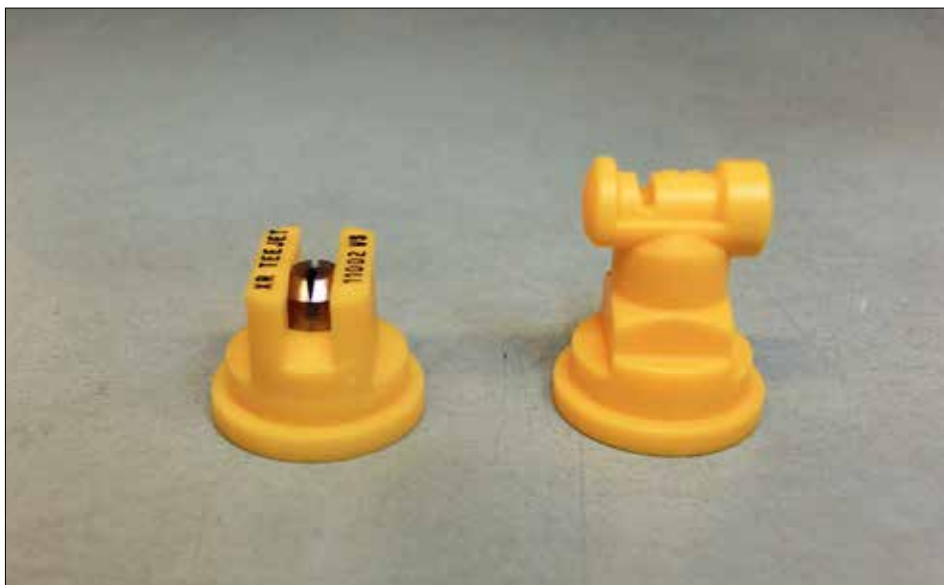
Fot. 40. Rozpylacze jednostrumieniowe rozmiar 02 (żółty): klasyczny (po lewej) i uderzeniowy (po prawej), różnią się charakterystyką wytworzonych kropli, gdy pracują pod tym samym ciśnieniem cieczy. Dla ciśnienia 0,3 MPa pierwszy klasyfikowany jest jako drobnokroplisty, a drugi jako średniokroplisty (fot. H. Ratajkiewicz)
