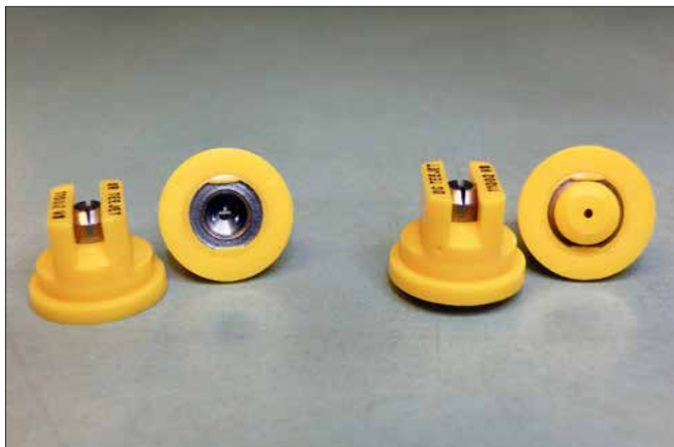
Fot. 41. Rozpylacz wyposażony w kryzę wstępną (po prawej) wytwarza krople większe i mniej podatne na znoszenie niż rozpylacz klasyczny (po lewej), mimo że ukształtowanie szczeliny wylotowej jest takie samo (fot. H. Ratajkiewicz)
