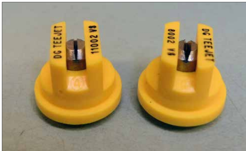
Fot. 42. Rozpylacze o różnym kącie strumienia kropli – 110° po lewej i 80° po prawej – różnią się ukształtowaniem (szerokością) szczeliny wylotowej, co skutkuje wytwarzaniem nieco większych kropli przez rozpylacz o węższym strumieniu (fot. H. Ratajkiewicz)
