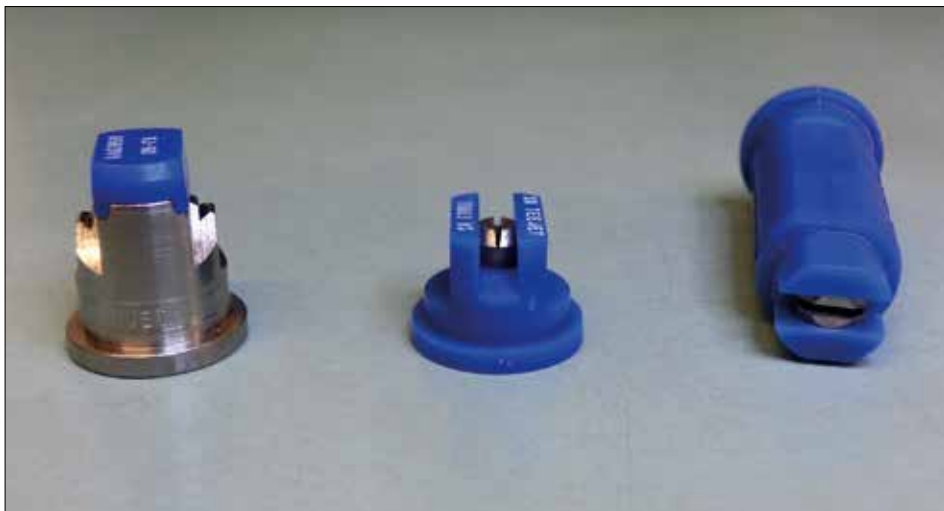
Fot. 39. Wielkość kropli wytwarzana przez rozpylacz o płaskim strumieniu zależy od jego konstrukcji. Przy tym samym wydatku i pod ciśnieniem 0,3 MPa rozpylacze przedstawione na zdjęciu klasyfikowane są następująco: bardzo drobnokroplisty – klasyczny rozpylacz dwustrumieniowy (po lewej), drobnokroplisty – klasyczny rozpylacz jednostrumieniowy (w środku), bardzo grubokroplisty – rozpylacz eżektorowy (po prawej) (fot. H. Ratajkiewicz)
