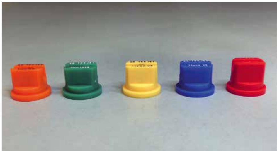
Fot. 38. Zgodnie z normami ISO kolor rozpylacza koduje jego wydajność cieczy w ciągu minuty. Rozpylacze o większym wypływie cieczy wytwarzają krople o większych rozmiarach, gdy pracują pod tym samym ciśnieniem. Od lewej rozmiary: 01; 015; 02; 03 i 04 (fot. H. Ratajkiewicz)
